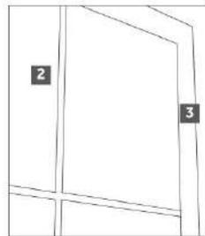
**1** - Jonc en aluminium poli brillant. **2** - Céramique effet bois. **3** - Les modèles de la collection SURFACE se distinguent par un parfait alignement extérieur entre l'ouvrant de la porte d'entrée et le cadre fixe, pour un design d'une grande pureté.
