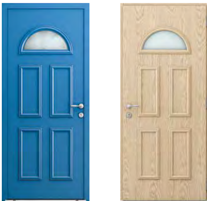
EXTÉRIEUR ALUMINIUM Couleur bleu 5023 S. Moulures embouties. Option poignée à saillie augmentée rosace ronde ton inox. Double ou triple vitrage retardateur d'effraction. Option vitrage clé de fleur. INTÉRIEUR BOIS Finition chêne champagne. Option moulures rapportées. Ud \geq 0,8 W/m 2 .K // Ud triple vitrage \geq 0,7 W/m 2 .K
