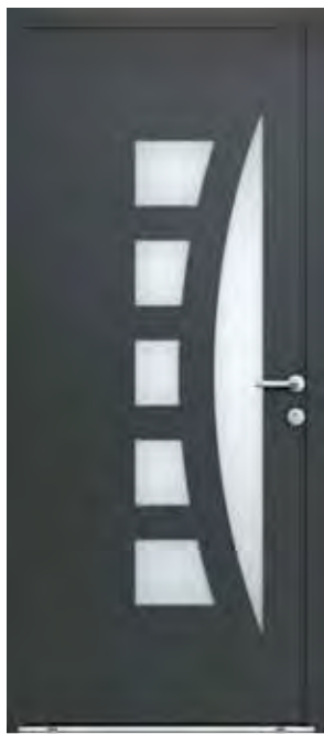
EXTÉRIEUR ALUMINIUM Couleur noir 2100 sablé. Double ou triple vitrage retardateur d'effraction. INTÉRIEUR BOIS Finition pin sablé. Ud \geq 0,9 W/m 2 .K // Ud triple vitrage \geq 0,8 W/m 2 .K
