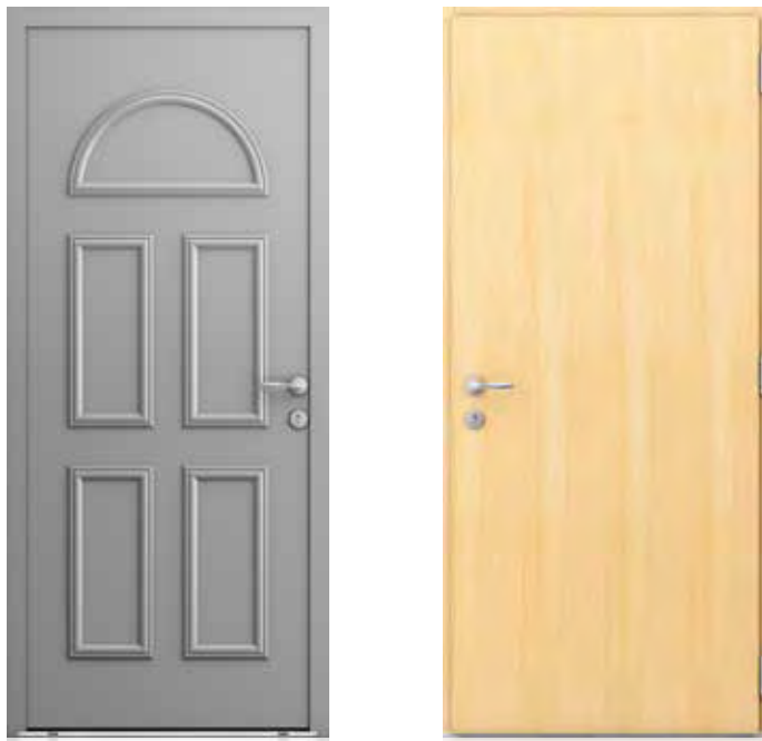
EXTÉRIEUR ALUMINIUM Couleur gris 9007 T. Moulures embouties. Option poignée à saillie augmentée rosace ronde ton inox. INTÉRIEUR BOIS Finition pin naturel. Ud \geq 0,7 W/m 2 .K
